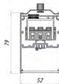
**Монтаж:** осуществляется на тросовые подвесы или скобы для крепления к потолку. Простой доступ к электрическим компонентам благодаря съемной верхней крышке корпуса. В конструкции предусмотрена магистральная проводка на 2 фазы, применен соответствующий силовой провод 1,5 кв.мм.
